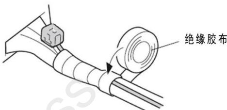
32. 剪开步骤 27 拔出的车辆 18 极接线器的胶布。
