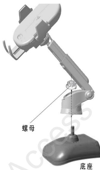
14. 调整无线充电器与底座的角度后拧紧步骤 13 中的螺母。
