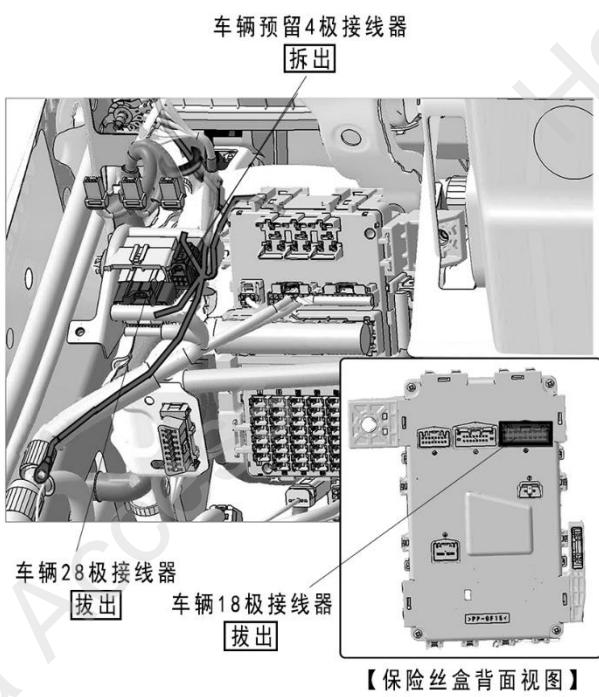
28. 剪开步骤 27 拔出的车辆 28 极接线器的胶布。
