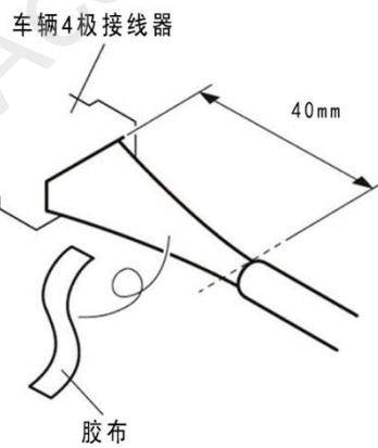
37. 连接线束的导线与车辆 4 极接线器。
