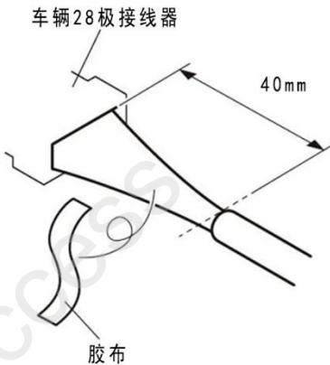
29. 连接线束的导线与车辆 28 极接线器。
