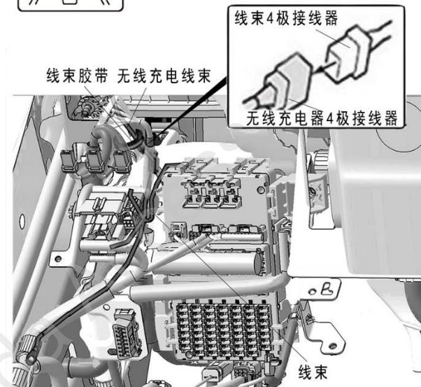
27. 拔出车辆 28 极与保险丝盒背面的 18 极接线器，拆出车辆预留的 4 极接线器。
