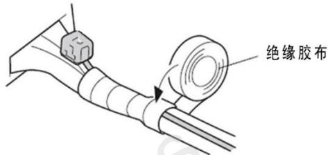
36. 剪开步骤 27 拆出的车辆 4 极接线器的胶布。
