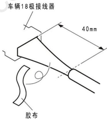
33. 连接线束的导线与车辆 18 极接线器。
